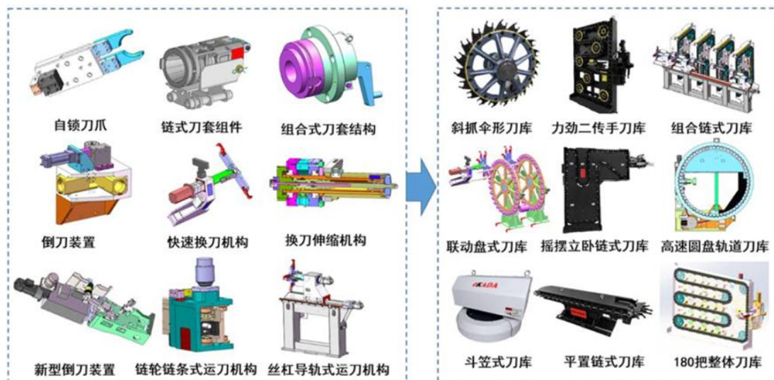
刀库及自动换刀装置关键结构件与整机产品新结构
