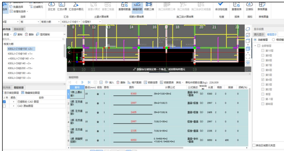
发行人某住宅楼某段梁钢筋计算式
