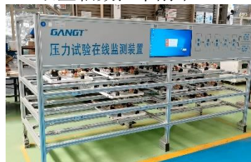
压力试验在线监测装置
