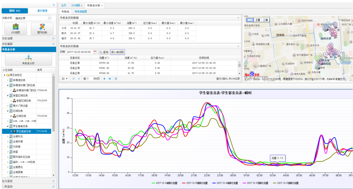
可能存在漏损的管段历史流量曲线图
