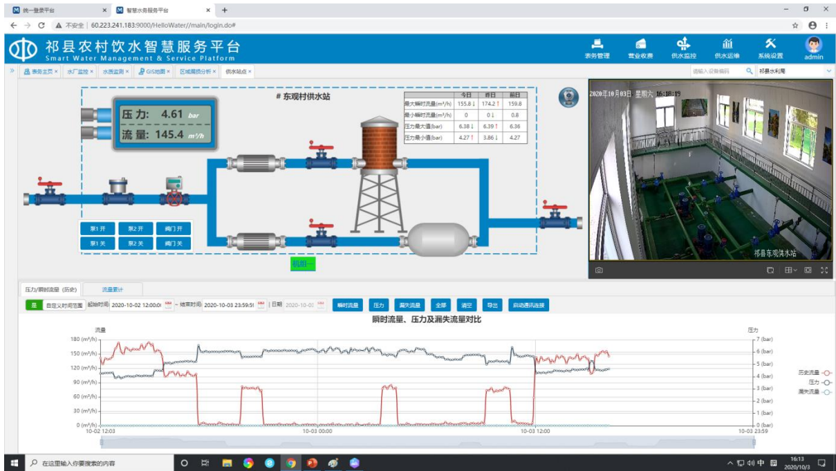
无漏损的管段历史流量曲线图
