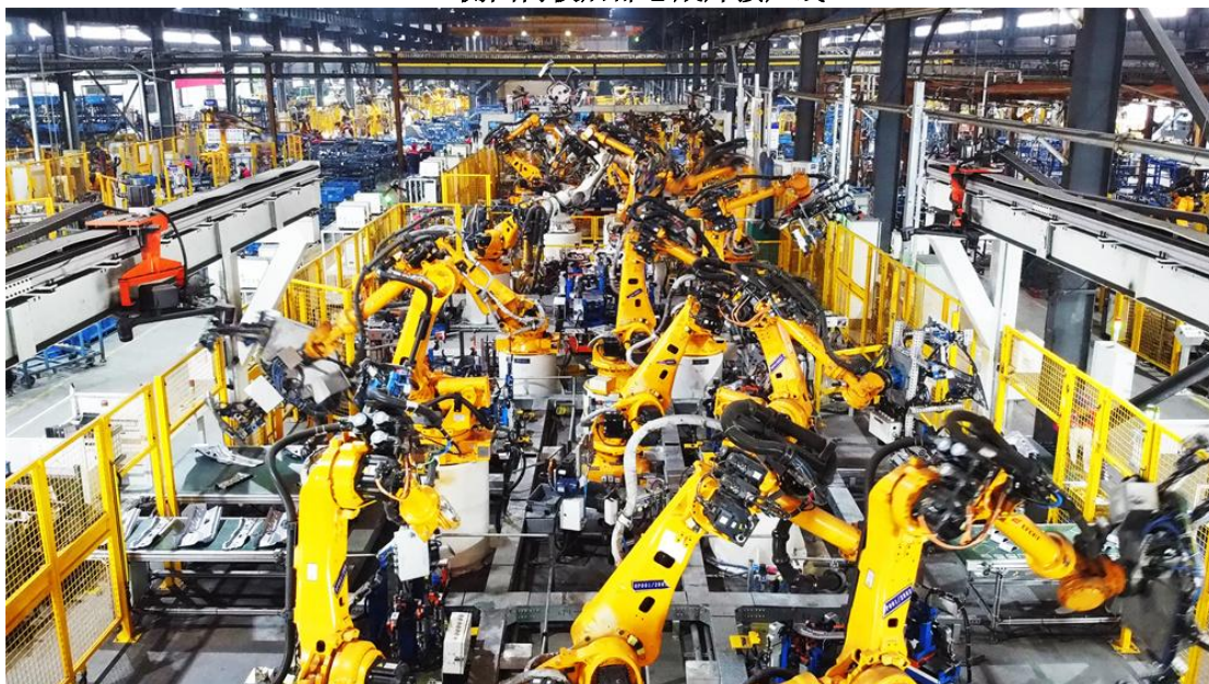
T18 侧围内板后部总成焊接产线
