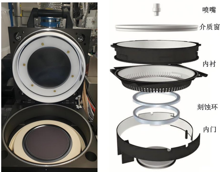
图：刻蚀设备反应腔示意图（左图）及装配示意图（右图）
