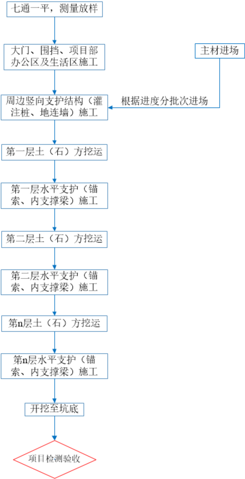
(10) 基坑土石方挖运施工工艺流程图
