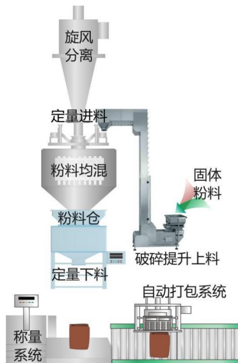
固体飞灰螯合剂的工艺流程图
