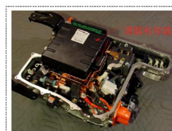
第二代丰田Prius电驱动系统控制器使用薄膜电容
