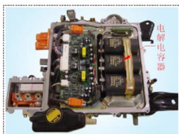
第一代丰田Prius电驱动系统控制器使用电解电容
