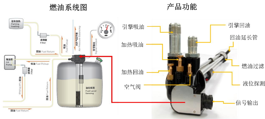
图：燃油传感器原理示意
