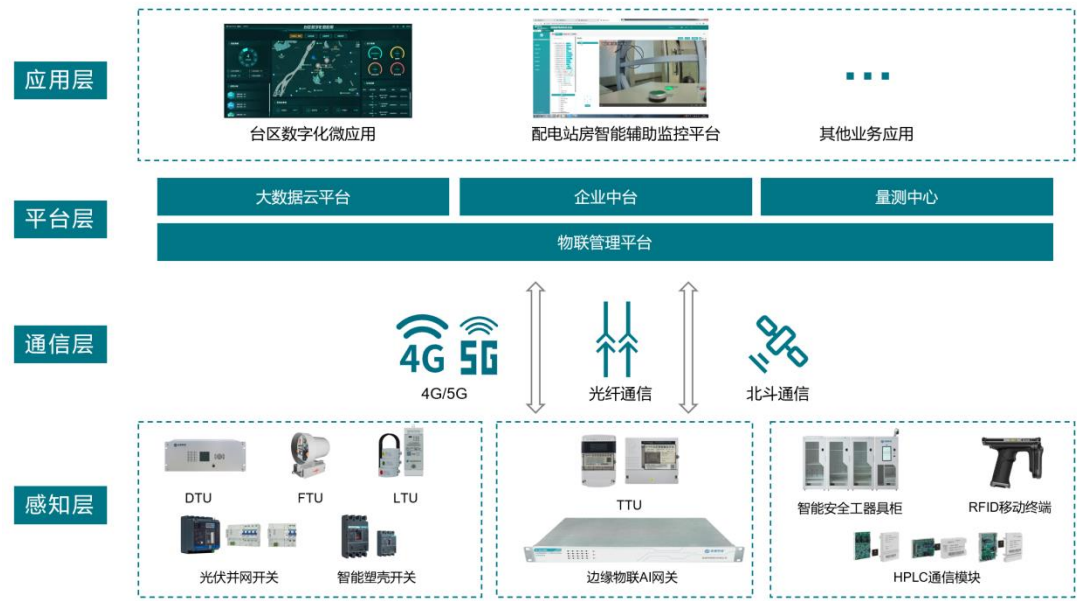
图：感知层、通信层、平台层、应用层的四层架构关系
