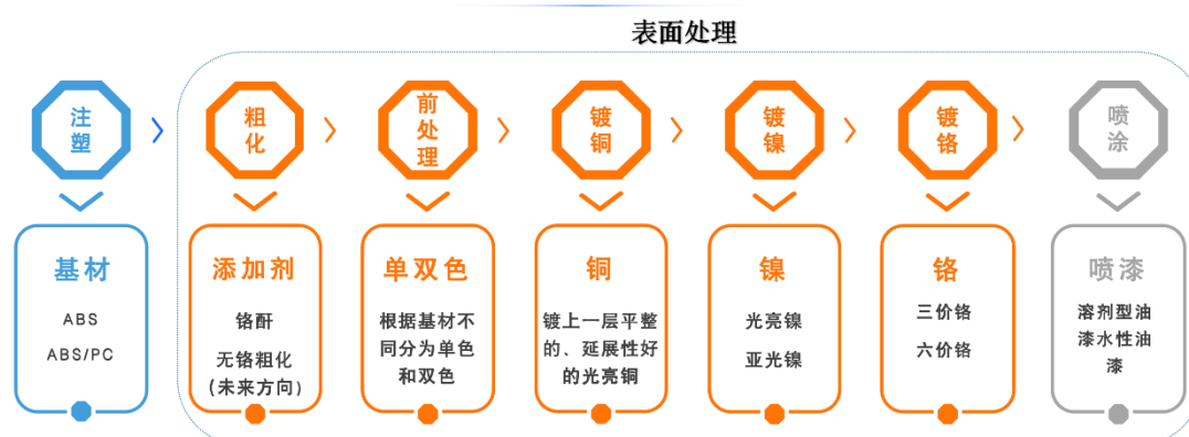
主流汽车内外饰件生产工艺核心环节示意图
