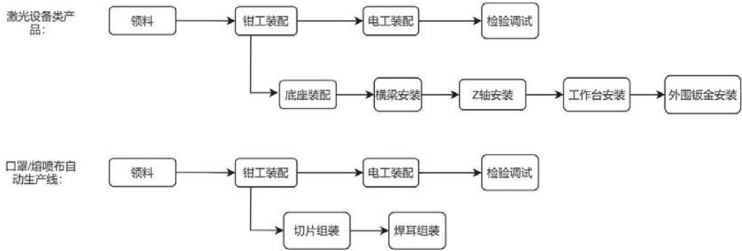
如上图所示，公司各类产品的主要生产工序较为接近，包括领料、钳工装配、电工装配和检验调试四个环节，其中钳工装配的具体工序根据产品类型不同有所差异。公司各产品相同工序所需的生产人员较为接近，主要包括钳工装配和电工装配环节所需的钳工和电工，其中钳工主要负责各项电控元器件、机械功能模组的结构装配，电工主要负责结构装配完成后的电气总装、上电、对点等后续工作。因此公司采用柔性生产，根据生产任务对设备、人员进行动态管理，生产人员根据工序进行管理。
