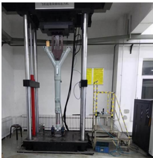
图：压缩试验测试
