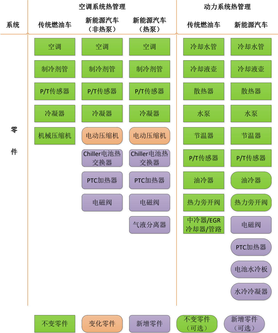
新能源汽车与传统燃油车热管理系统差异图
