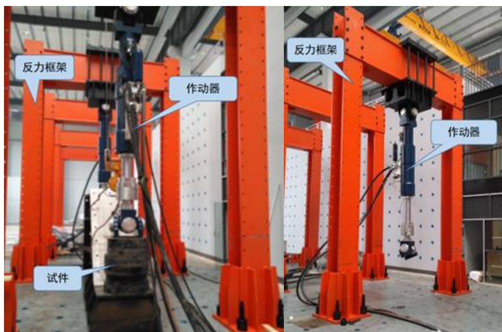
土木工程综合加载试验系统实物图
