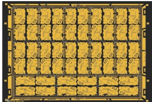
某款高频高速板： 铜面积比：66.78% 孔铜厚度：平均 20μm 内层铜厚：35μm 成品铜厚：50μm
