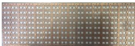
SOP 8L 的 8 排引线框架
