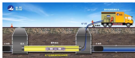
鼓风吹气, 送入紫外灯架, 紫外固化
