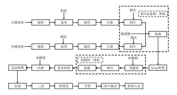
由上图可知, 欣旺达的锂电池产品生产过程主要包括极片制作(正负极片的涂布、辊压、分条)、极片卷绕(极耳焊接、贴胶、卷绕、预压以及短路检测等)、注液及密封(软包电池包括一次封装及二次封装工序)、电池化成以及分容等, 其中极片卷绕以及电芯密封等是电芯制造过程的重要工序。
