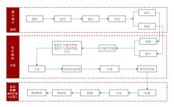
由上图可知,方形铝壳电池在其中段的电芯制造工序中可采用卷绕、叠片两种工艺,现阶段我国电芯制备以卷绕工艺为主。截至 2023 年 2 月末,公司已向欣旺达发出两台动力卷绕机进行测试,目前已进入量产验证阶段。在前述动力卷绕机验证良好的基础上,2023 年 3 月,公司进一步取得了 12 台欣旺达动力卷绕机订单。因此,公司相关动力电池生产设备适用于欣旺达相应产品的工艺路线,公司动力锂电产品技术路线亦与欣旺达一致。
