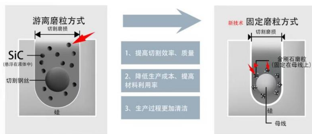
传统的砂浆切割和金刚石线切割工作原理示意图
