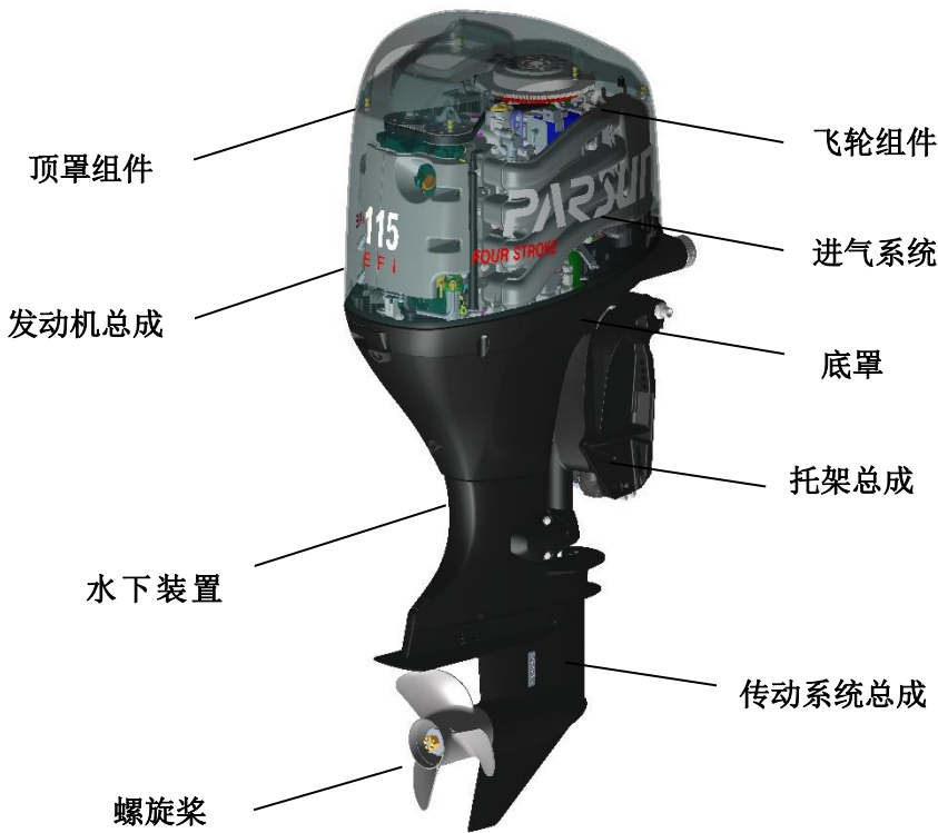
公司 115 马力舷外机产品结构图示
