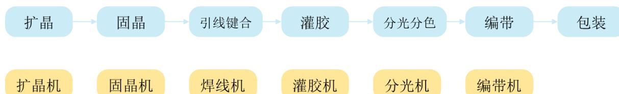
注：标蓝部分为 LED 封装相关工序，标黄部分为工序对应的专用设备。
