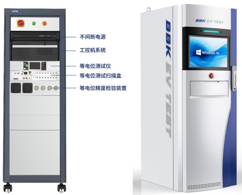
电动车动态测试台效果图
