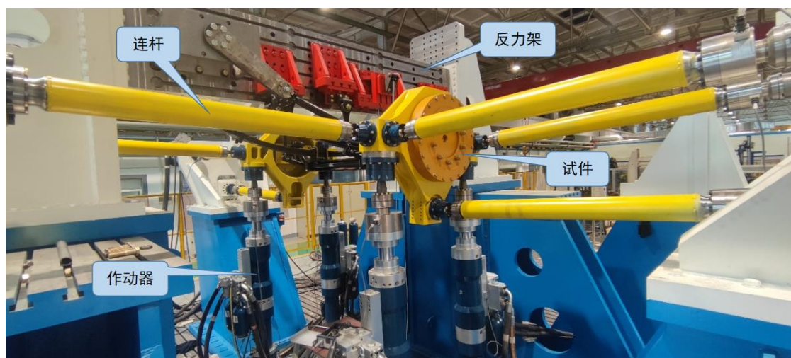
十二通道轴耦合试验台架实物图
