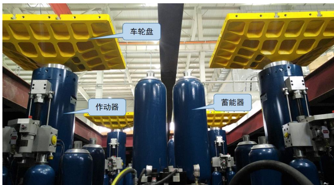
六通道道路模拟试验台实物图
