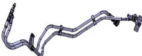
图 6.3 汽车燃油蒸发排放管理总成示意图
