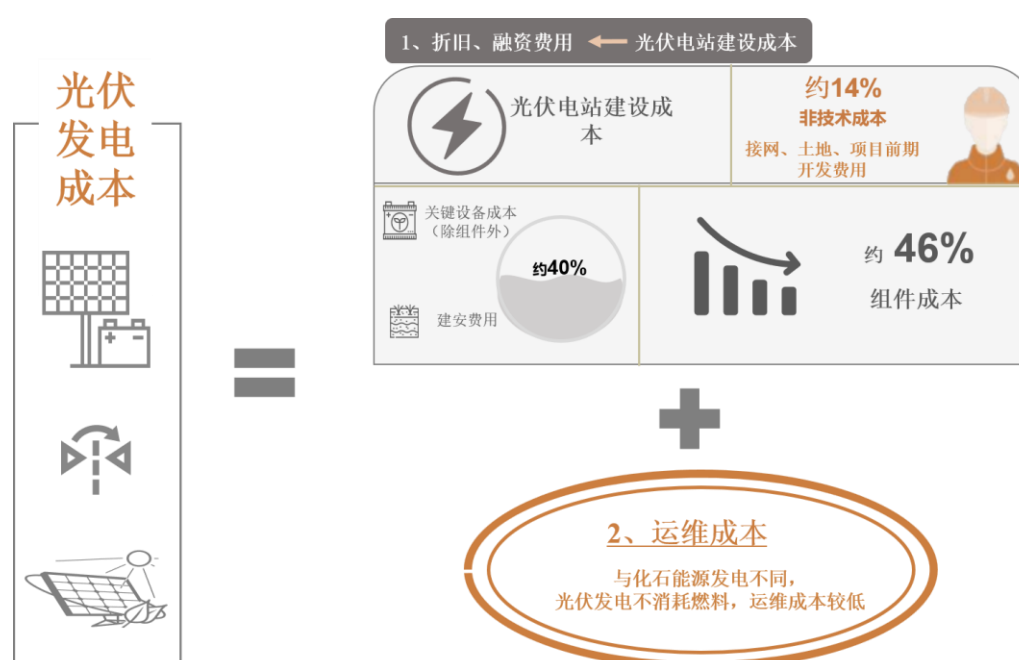
（光伏发电成本构成示意图）
