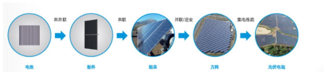
（光伏电站系统构成图示）
