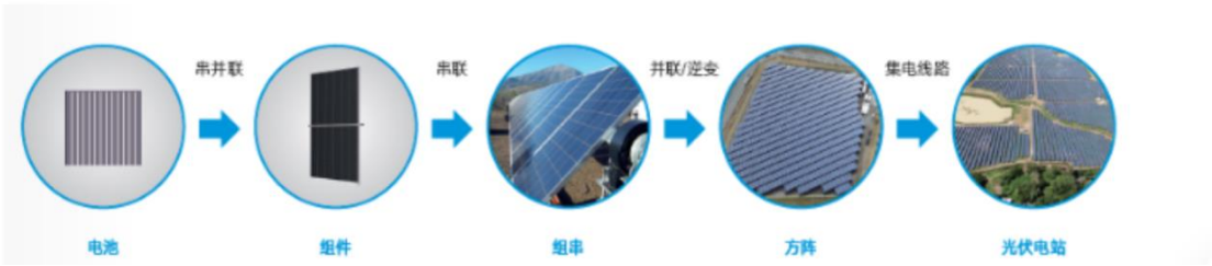
（光伏电站系统构成图示）
