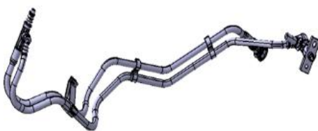
图 6.3 汽车燃油蒸发排放管理总成示意图
