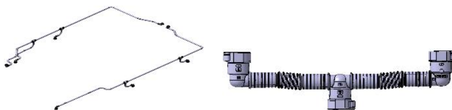
图 6.6 新能源汽车热管理系统管路总成示意图
