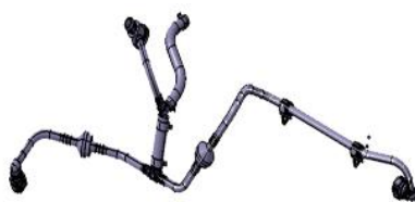
图 6.5 汽车真空制动管路总成示意图
