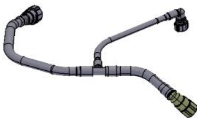
图 6.4 汽车曲轴箱强制通风管路总成示意图
