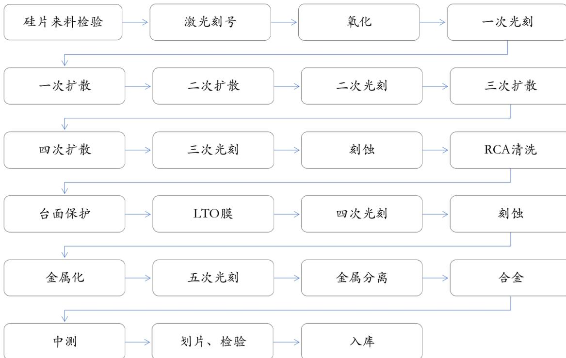
2、保护器件芯片制造流程图（以 ESD 芯片为例）
