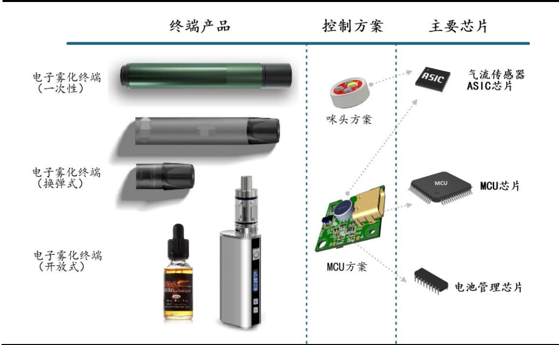
图：应用于电子雾化终端领域的主要芯片类型
