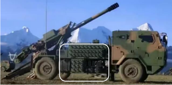
复合材料弹药箱（非公司产品原型车）
