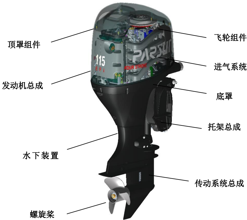
公司 115 马力舷外机产品结构图示
