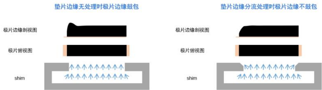
垫片定制化边缘设计能有效改善涂膜边缘削薄
