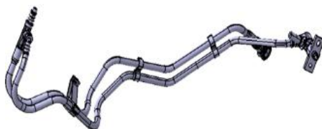
汽车燃油蒸发排放管理总成示意图
