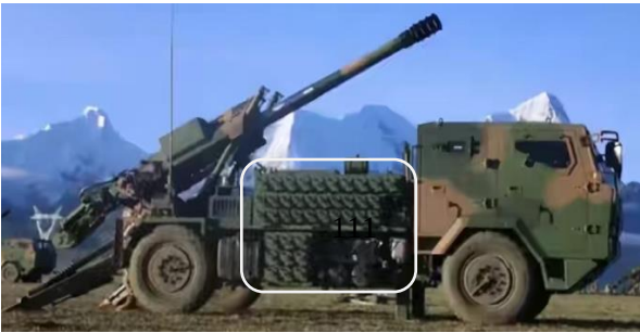
复合材料弹药箱（非公司产品原型车）
