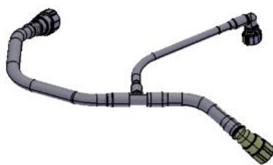
汽车曲轴箱强制通风管路总成示意图
