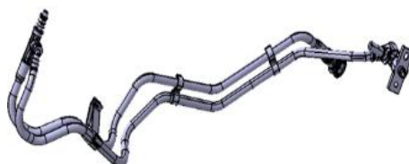
汽车燃油蒸发排放管理总成示意图
