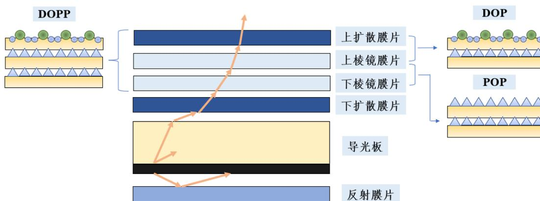
在光学膜材生产业务中，目前公司主要生产棱镜-棱镜复合膜（POP），通过溶剂调配、光学微结构成型、涂布贴合等多道工序，将光学基膜加工成具备特殊光学特性的复合材料，其与普通两层光学膜相比，膜片厚度变薄，使得整个背光膜组变薄，可以更好的满足液晶显示大尺寸、薄型化的需求。同时在背光模组组装时因膜片数量减少，组装工序减少，作业时间减少，从而有效提升组装良率以及降低制造人力成本。
