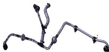
图 6.5 汽车真空制动管路总成示意图
