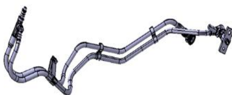
图 6.3 汽车燃油蒸发排放管理总成示意图
