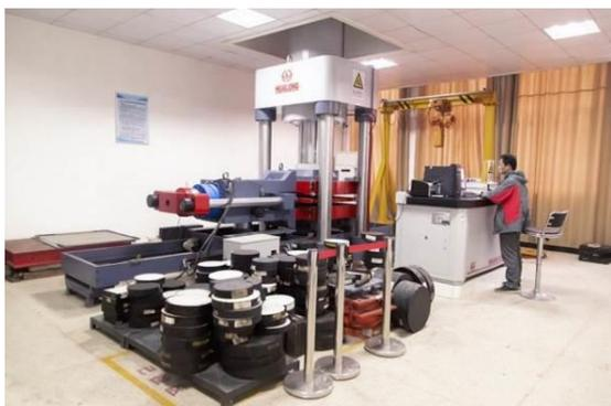
盆式支座竖向压缩变形试验
