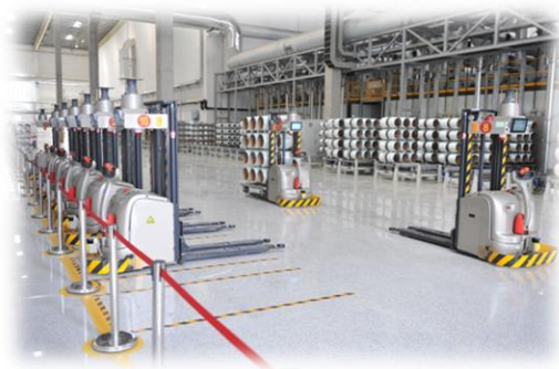
AGV 搬运系统
