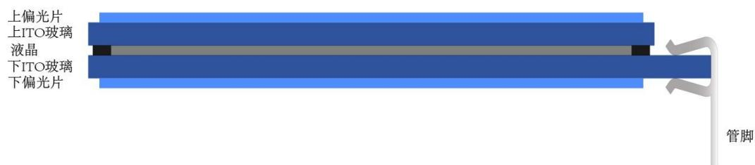
根据填充在 ITO 玻璃之间液晶的排列方式的不同，单色液晶显示屏主要分为 TN 型（扭曲向列型）、HTN 型（高扭曲向列型）、STN 型（超扭曲向列型）、VA 型（垂直定向型）等。
