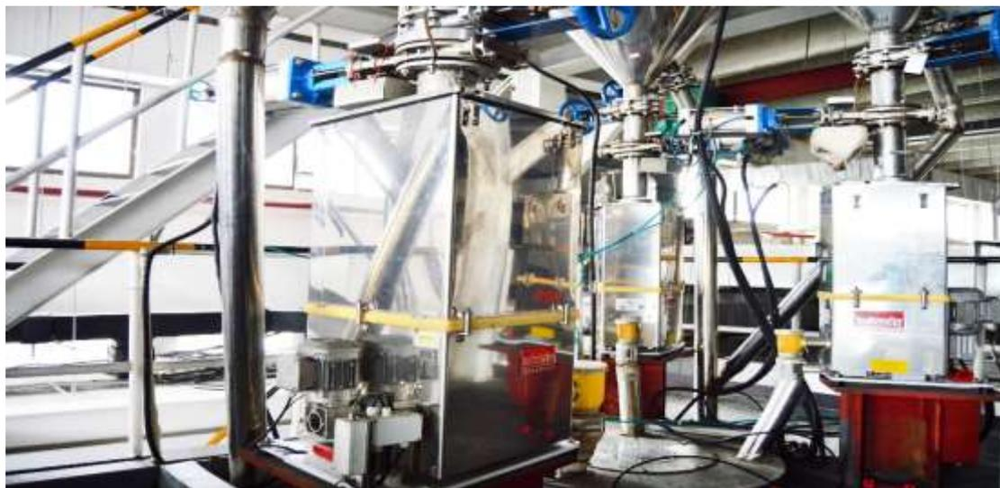
2、结晶和干燥。聚酯切片容易在空气中吸收水分，在进行双向拉伸之前，必须先进行预结晶和干燥处理。其作用是：提高聚合物的软化点，避免其在干燥和熔融挤出过程中树脂粒子互相粘连或结块；去除树脂中的水分，防止在熔融挤
