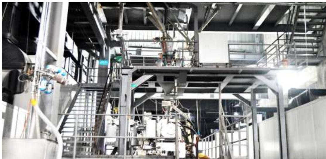
4、铸片：铸片是将挤出机输送来的均匀稳定的熔体通过模头流延在转动的急冷辊上，使之形成无定型的厚片，供下道工序拉伸使用。铸片系统由模头、急
