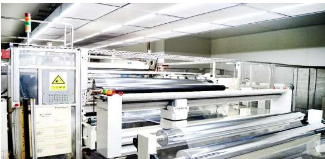
6、横向拉伸。横向拉伸系统由烘箱、链夹和导轨、静压箱、链条张紧器、导轨宽度调节装置、开闭夹器、热风循环系统、润滑系统及控制系统等组成，其作
