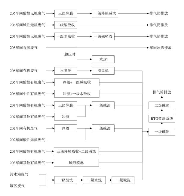
酸性无机废气主要包括氯化氢等,碱性无机废气主要包括氨气等。206 车间的高浓度酸性无机废气经三级降膜+一级降膜碱洗达标后排放;206 车间的碱性无机废气经二级酸吸收达标后排放;207 车间的酸性无机废气经一级水吸收+一级碱吸收达标后排放。
