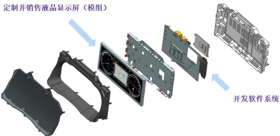
上图为全液晶仪表系统的简易结构图，发行人硬件业务涉及定制、销售该整
