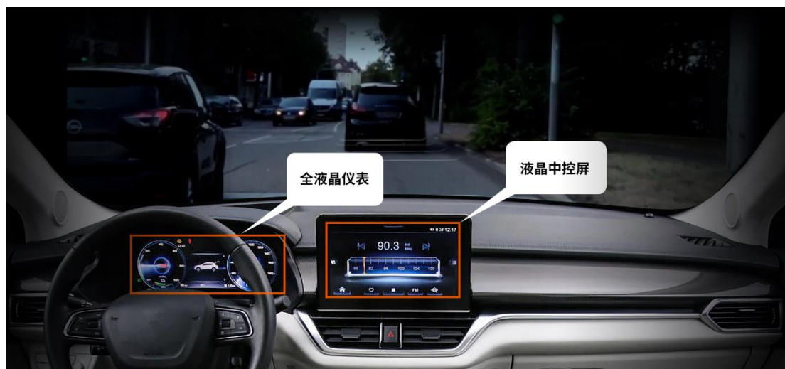
第四阶段：全液晶仪表+液晶显示的中控+增强现实抬头显示
