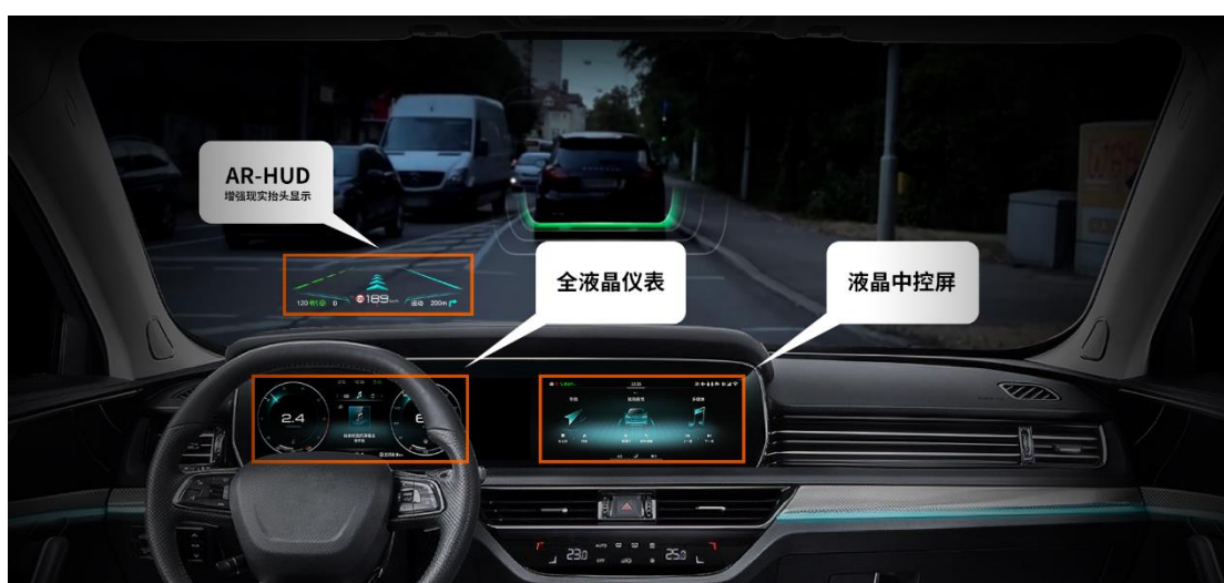
第四阶段：全液晶仪表+液晶显示的中控+增强现实抬头显示
